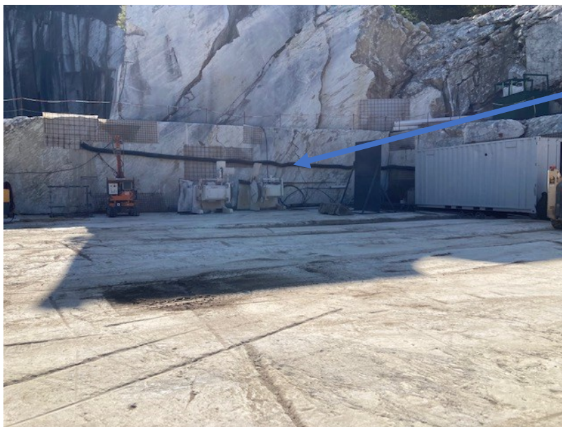
Fig.1 tubazione di raccolta amd ricadenti sul piazzale superiore non più coltivato
