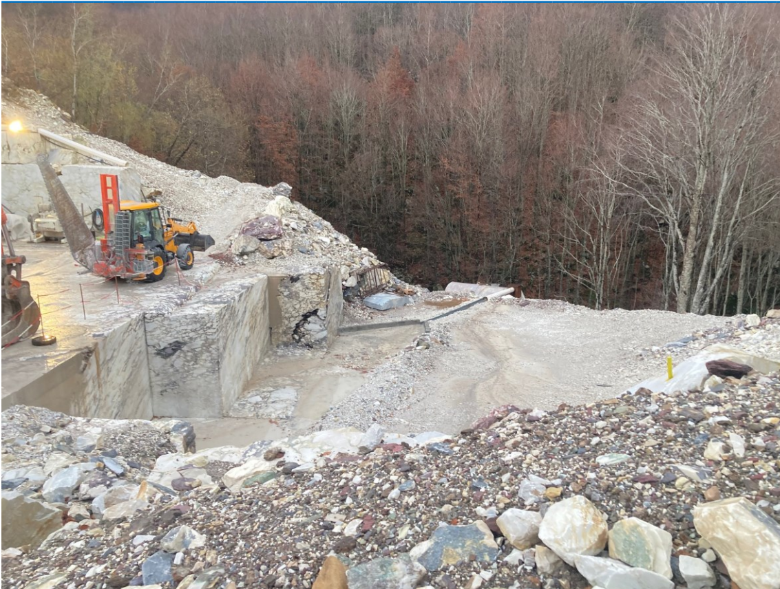
Fig.2 Punto di raccolta AMD a valle della zona di coltivazione attiva ed al piede della zona di accumulo dei derivati
